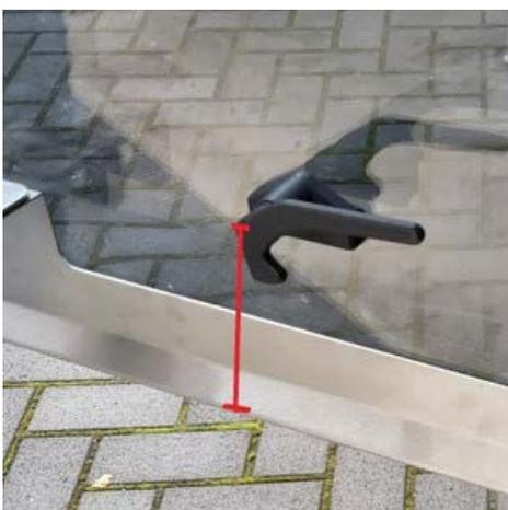
Das folgende Maß wird bei Kastenwagen und Vans mit lang auf das Fahrzeugblech überhängenden Fenstern (rahmenlos) benötigt. Der angezeigte Abstand (Drehpunkt des Riegels zur Fensterunterkante) beträgt ca. 7 – 13 cm.
